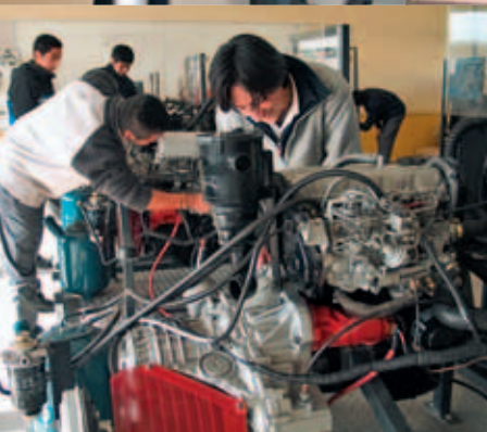
Alumnos examinan las partes y piezas de un motor bencinero estacionario.
