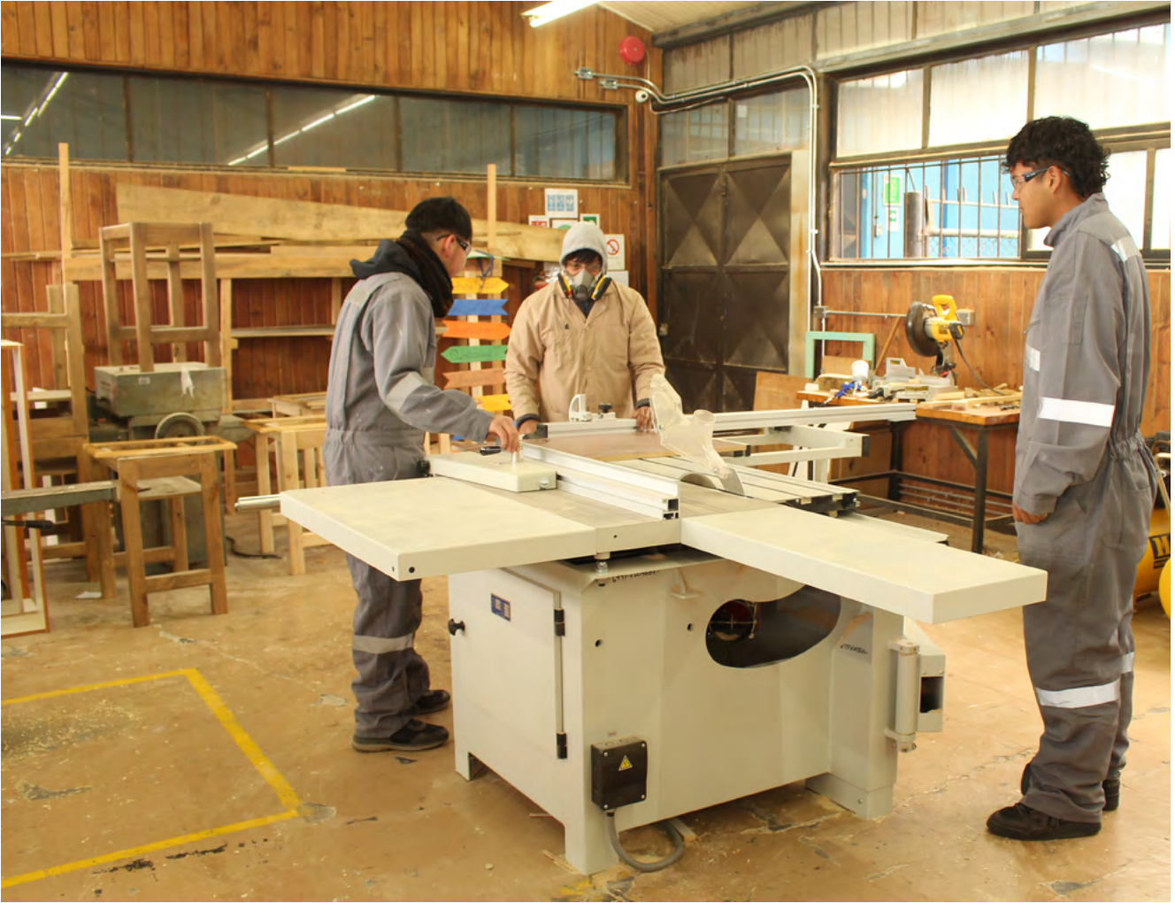
ESTUDIANTES DE LA ESPECIALIDAD DE MUEBLES Y TERMINACIONES EN MADERA DEL LICEO BICENTENARIO CLAUDIO ARRAU LEÓN DE CARAHUE. EN LA FOTOGRAFÍA, TRABAJAN CON LA AYUDA DE UNA ESCUADRADORA DE ALTA PRECISIÓN.
