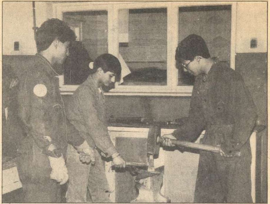
El alumno monitor señala el uso incorrecto de brazaletes durante el trabajo en el taller de forja.
