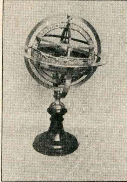
Esfera armilar. Instrumento astronómico formado por varios aros o anillos (armillas). Se empleaba para mostrar al alumno los círculos del espacio celeste, así como sus posiciones relativas en relación a la tierra ubicada en el centro (Colección Material Didáctico del Museo Pedagógico).
