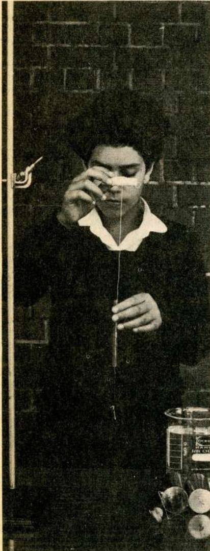
Foto N° 4. Hilo elástico que atraviesa la envoltura de un lápiz de pasta y que se utiliza como dinamómetro.
