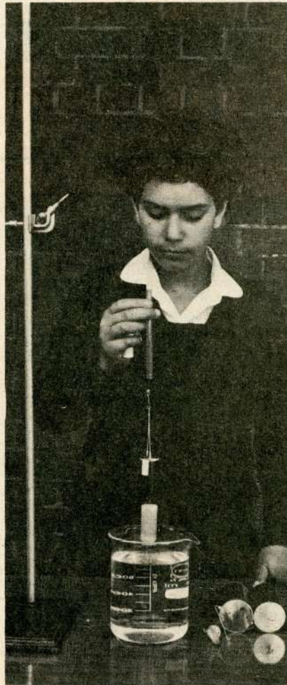
Foto N° 5. El cilindro macizo confeccionado con parafina sólida se cuelga del dinamómetro y se sumerge en el líquido.
