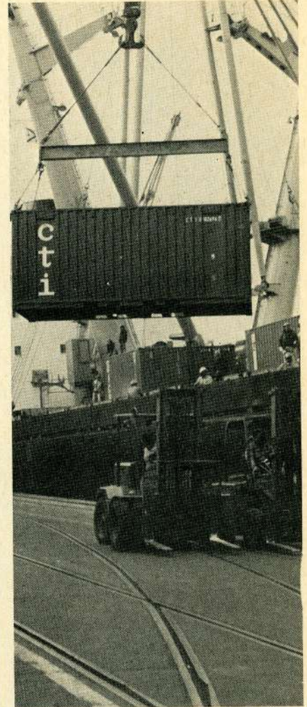
Los contenedores son cajas metálicas de construcción sencilla y resistente. Sus medidas más frecuentes son 8 por 8 por 20 pies y 8 por 8 por 40 pies.
