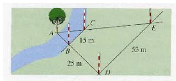
Los segmentos  $BC$ ,  $BD$  y  $DE$  tienen las medidas dadas y con el teorema de Tales se puede determinar el ancho del río:
