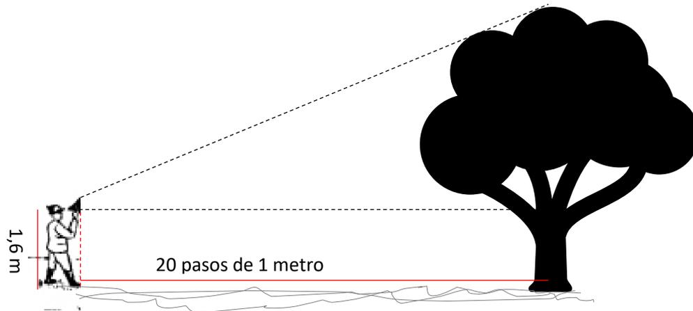
El docente explica la necesidad de conocer las características o medidas del instrumento para determinar la altura del árbol y cómo la proporción ayuda a resolver el problema. Para esto, se sugiere hacer un esquema de la situación incluyendo las medidas del instrumento, relevando el uso del plomo para obtener la medida de  $90^\circ$  y lograr un triángulo semejante.
