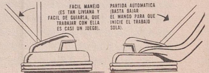
SISTEMA DE ASPIRACION FRONTAL (ANTES QUE LAS ESCOBILLAS ACTUEN, LA ASPIRADORA ELIMINA HASTA LA ÚLTIMA PARTICULA DE POLVO).
