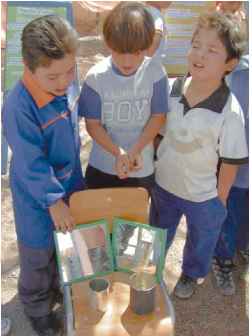
Midiendo la temperatura del agua expuesta a la refracción por espejo y sin ella.
